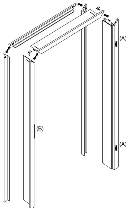
Eine druckfeste Hinterlegung der Zarge zum Mauerwerk mit Hartholz im Band- und Schließblechbereich ist Voraussetzung für einen jahrelangen sicheren Halt!
